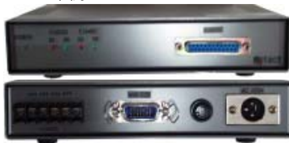
回線コントローラ
